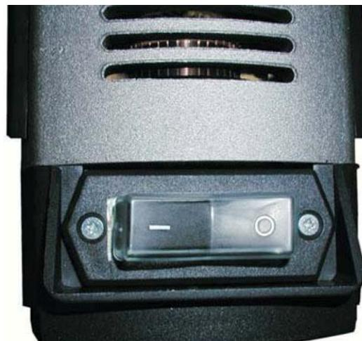
Главный выключатель питания находится в задней части бормотора. Чтобы подать питание на электронику управления мотором, включите клавишу выключателя в положение «1». Мотор выполняет «плавный пуск» и выходит на полные обороты в течение 2-3 сек.
